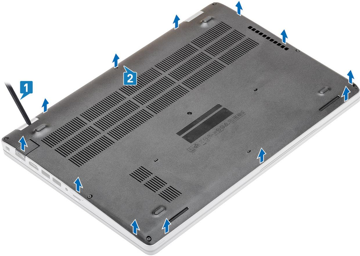
3. Heben Sie die Bodenabdeckung an und entfernen Sie sie aus dem Computer.
