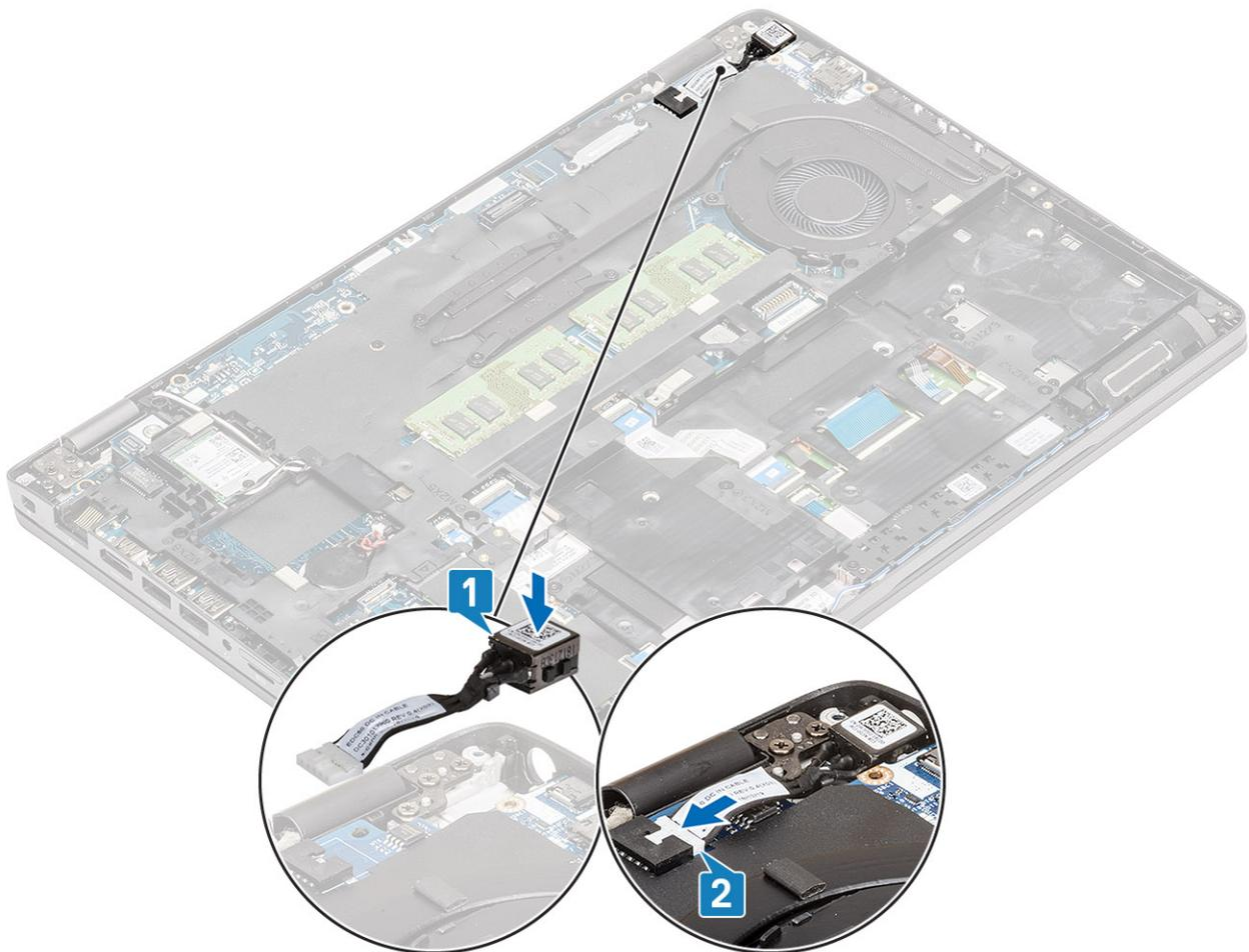
3. Platzieren Sie die USB-Typ-C-Halterung am entsprechenden Steckplatz am Computer [1].
