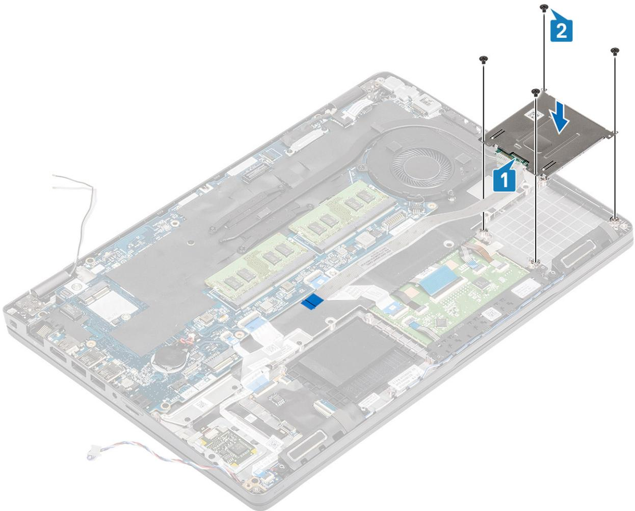
3. Schließen Sie das flexible Flachbandkabel (FFC) des SmartCard-Lesegeräts an den Anschluss auf der USH-Platine an [1].
