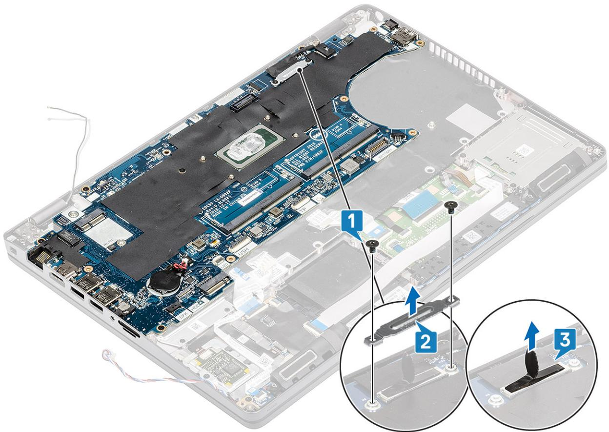
6. Entfernen Sie die fünf Schrauben (M2x3), mit denen die Systemplatine am Computer befestigt ist [1].
