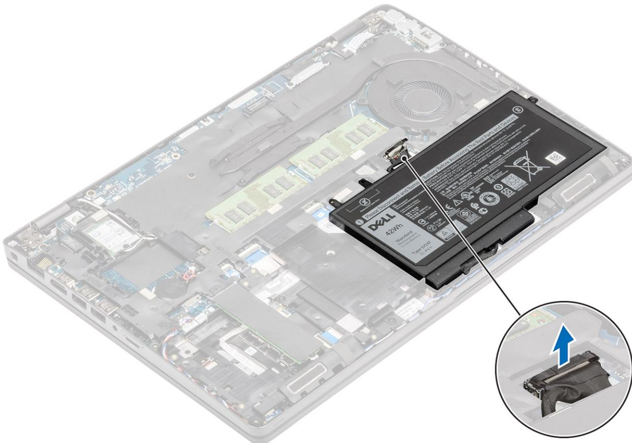
2. Lösen Sie die einzelne unverlierbare Schraube, mit der der Akku an der Handauflagenbaugruppe befestigt ist [1].
