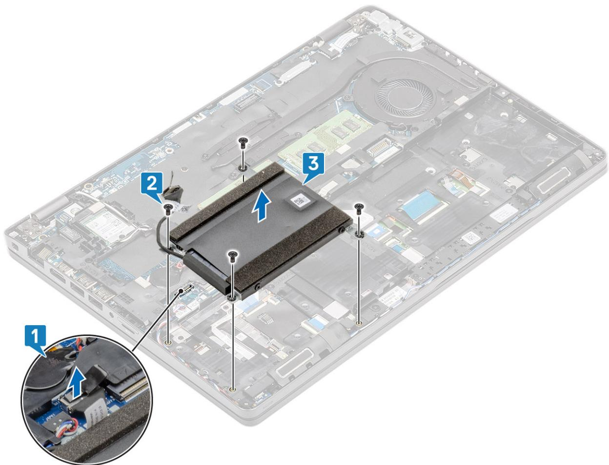
2. Entfernen Sie die vier Schrauben (M2x2,7), mit denen die Festplattenbaugruppe befestigt ist [2].
