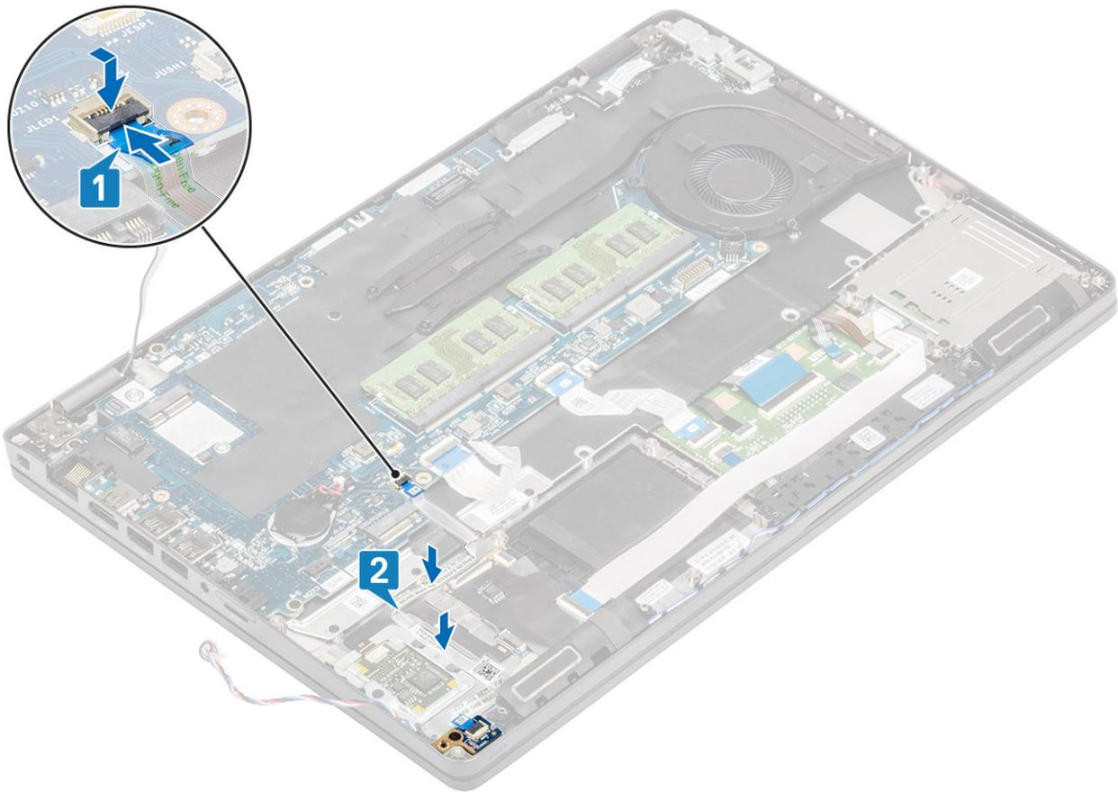
4. Schließen Sie das flexible Flachbandkabel (FFC) für die U.S.H-Tochterplatine an und befestigen Sie es [1, 2].
