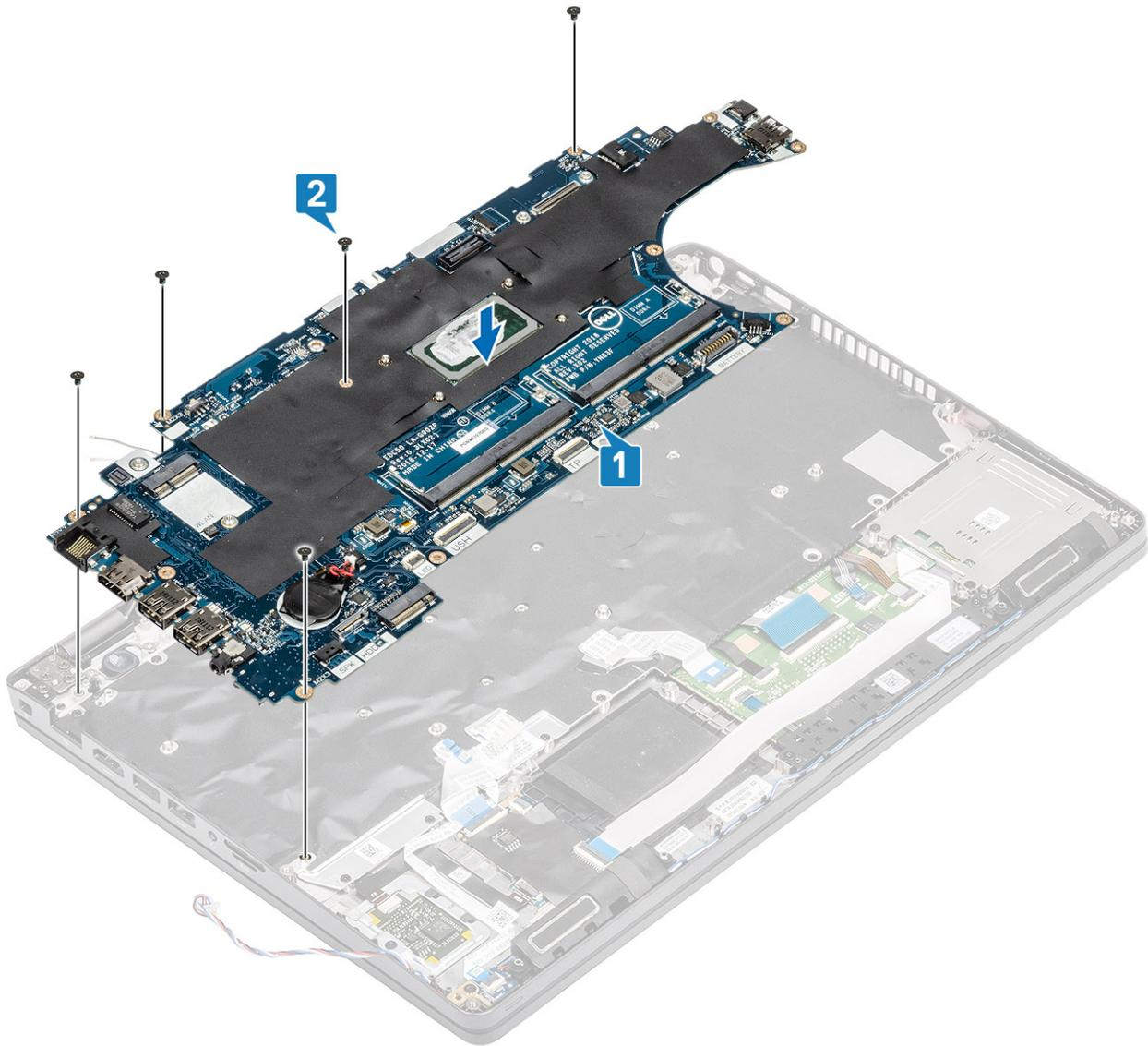
3. Verbinden Sie das eDP-Kabel mit dem Anschluss auf der Systemplatine [1].
