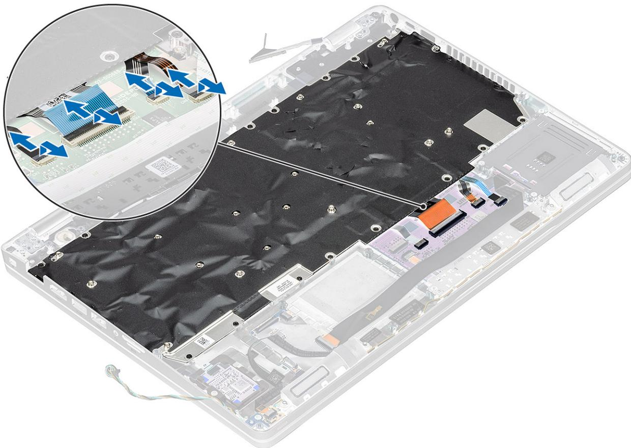
2. Entfernen Sie die 22 (M2x2)-Schrauben, mit denen die Tastatur an der Handballenstütze befestigt ist [1].
