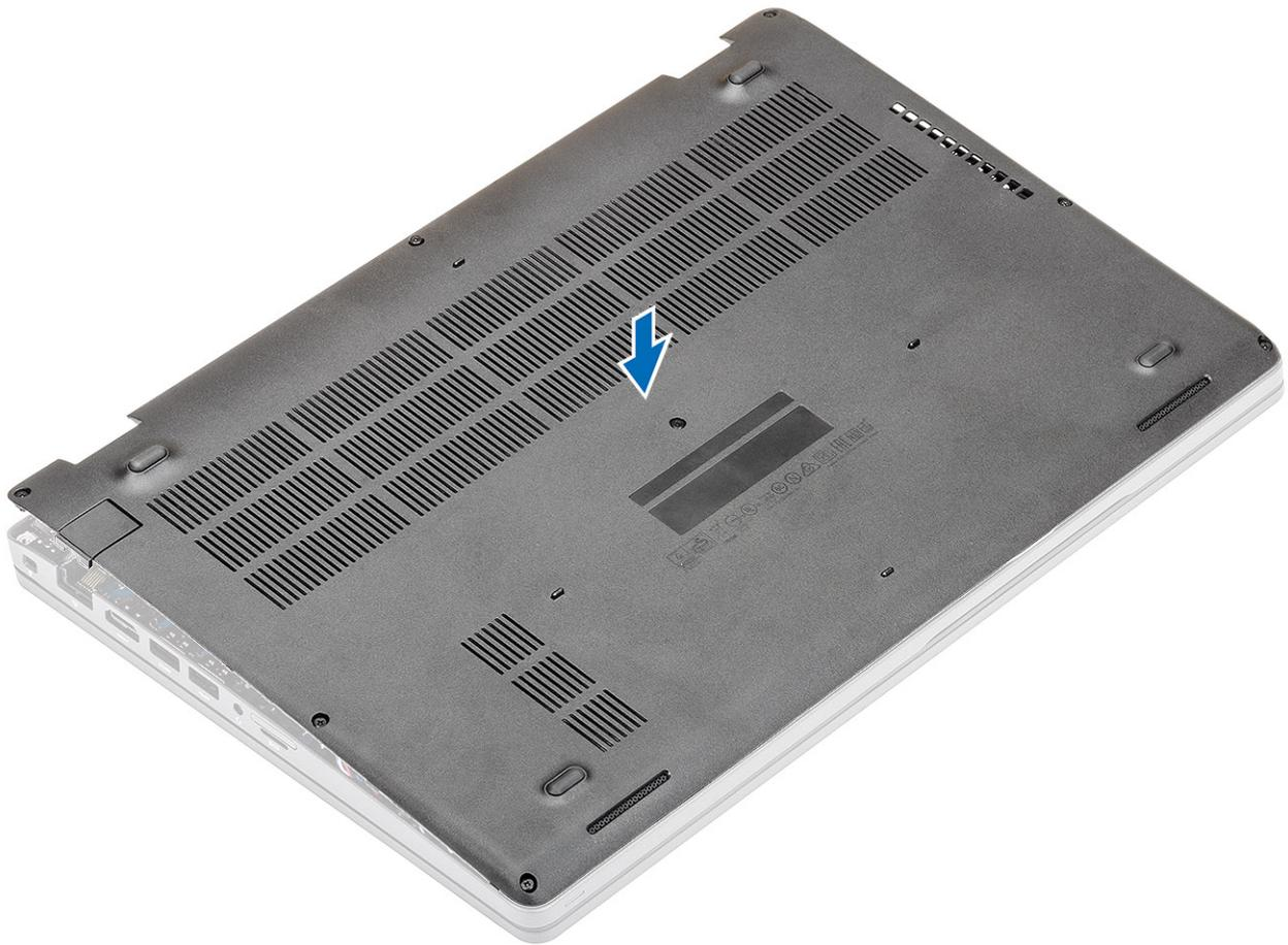
2. Drücken Sie auf die Kanten und die Seiten der Bodenabdeckung, bis die Abdeckung einrastet.
