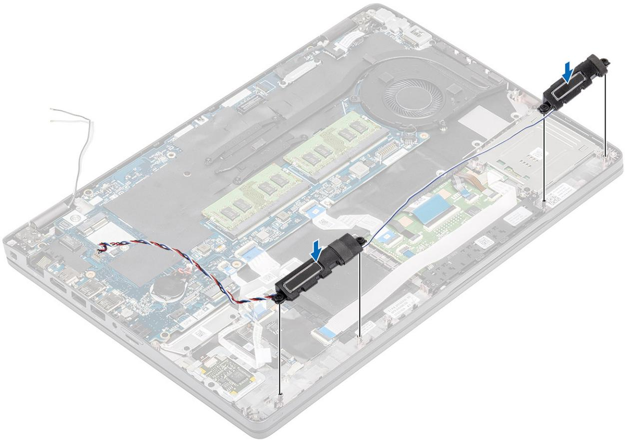
3. Bringen Sie das Klebeband zur Befestigung des Lautsprecherkabels an der Handballenstütze an [1].
