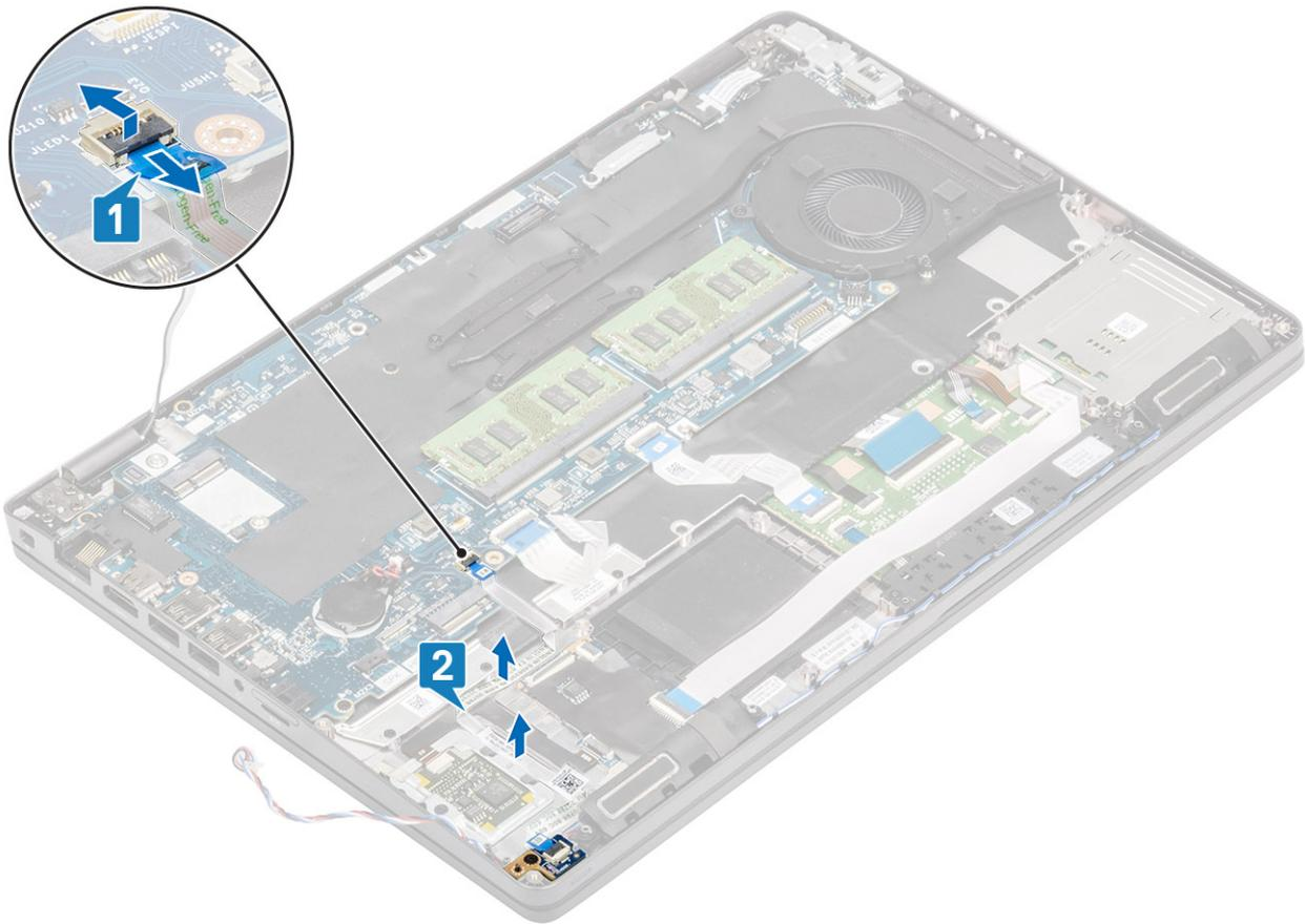
4. Entfernen Sie die einzelne Schraube (M2x3), mit der die LED-Platine an der Handballenstütze befestigt ist [1].
