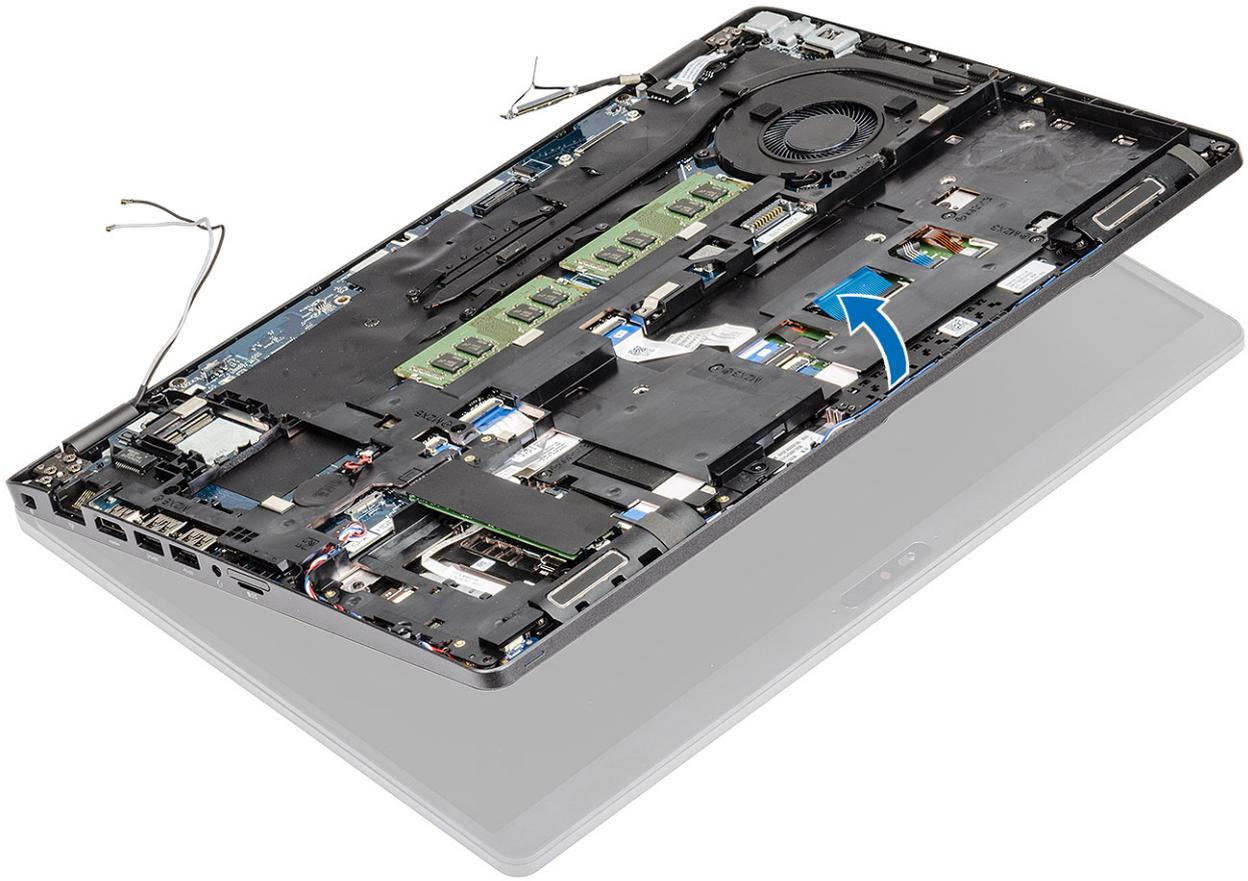
6. Entfernen Sie die sechs Schrauben (M2,5x4), mit denen die Bildschirmbaugruppe am Systemgehäuse befestigt ist [1].
