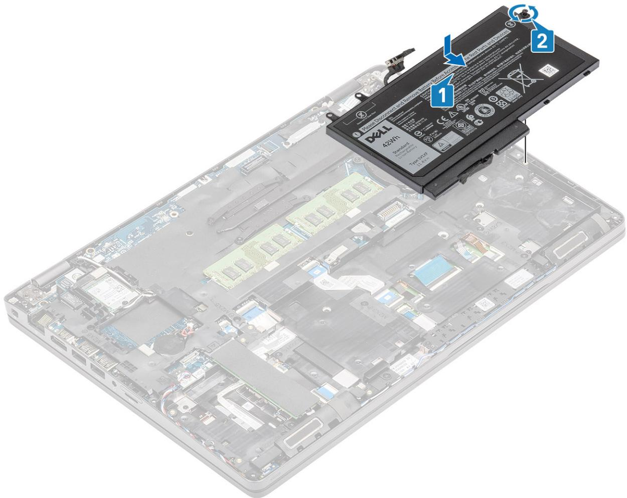
4. Verbinden Sie das Batteriekabel mit dem Anschluss an der Systemplatine.
