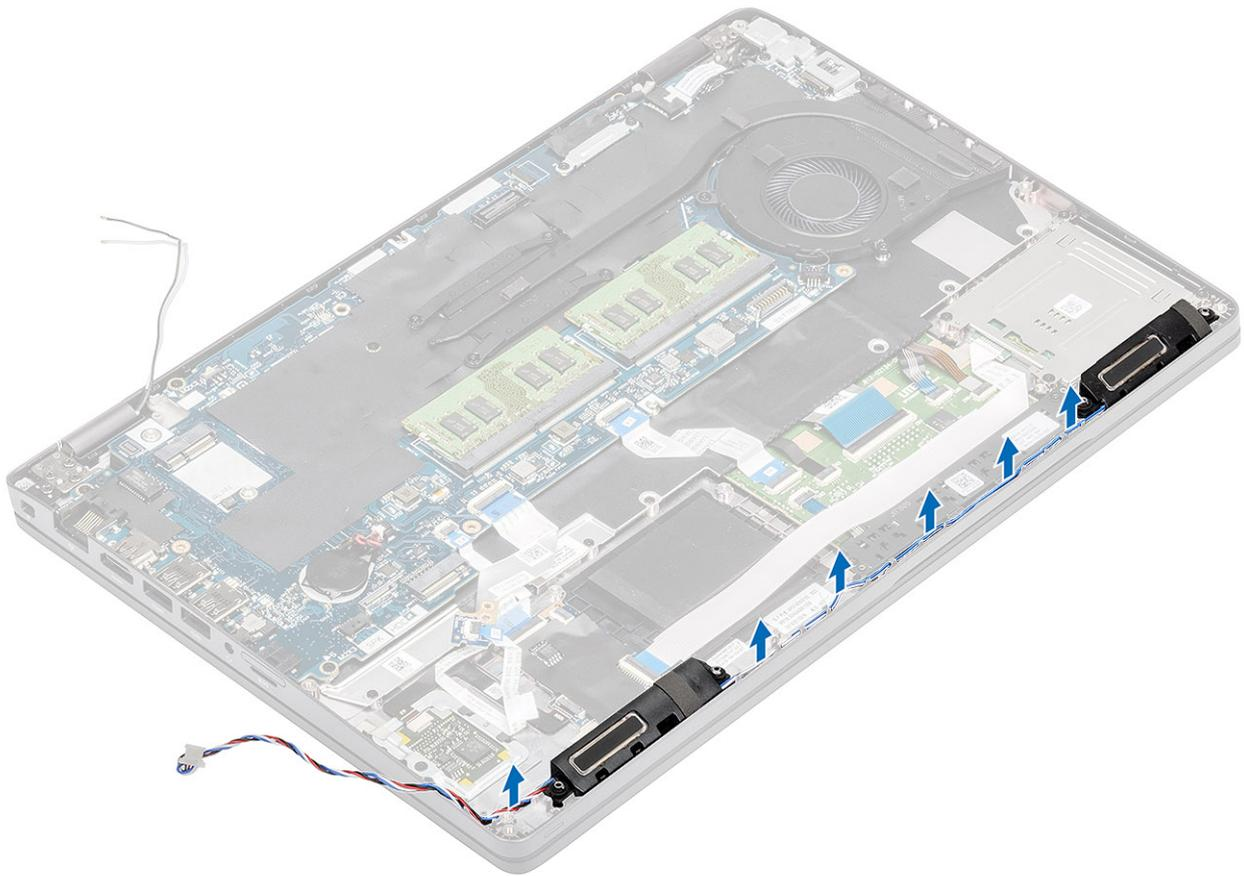
3. Heben Sie die Lautsprecher von der Handballenstütze ab, um sie zu entfernen.
