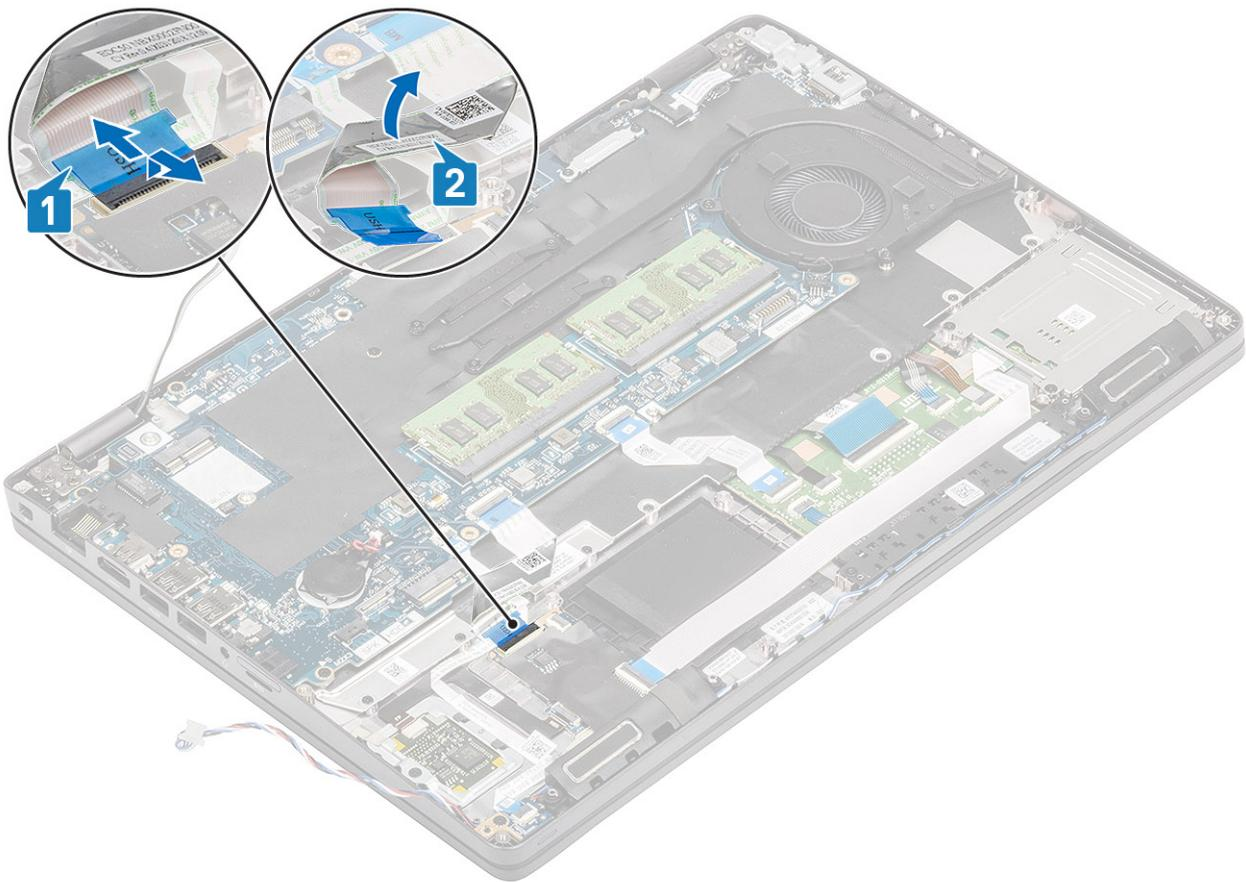
2. Trennen Sie das LED-Platinenkabel vom Anschluss auf der Systemplatine [1].
