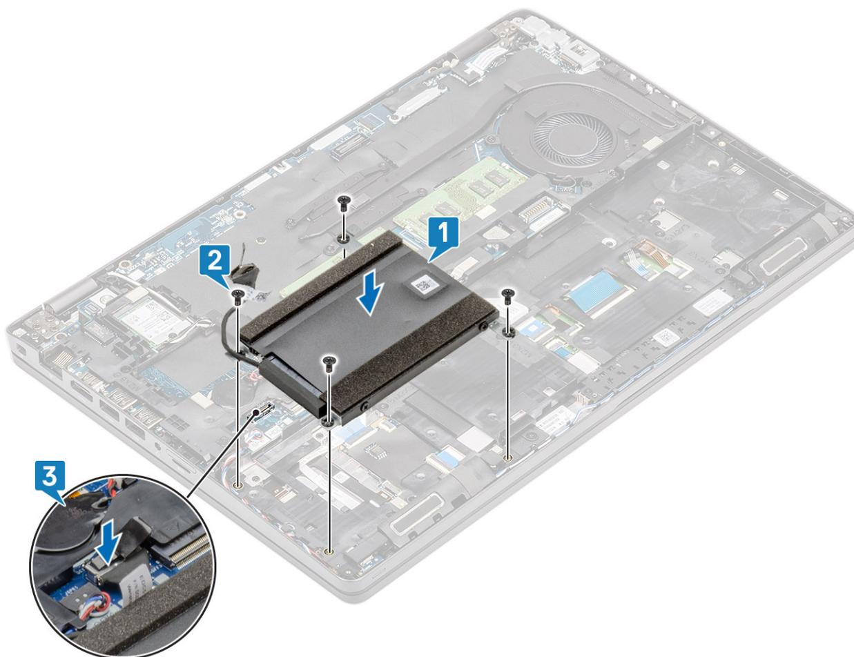
5. Ziehen Sie die vier Schrauben (M2x2,7) fest, um das Festplattenlaufwerk am Computer [2] zu befestigen.
