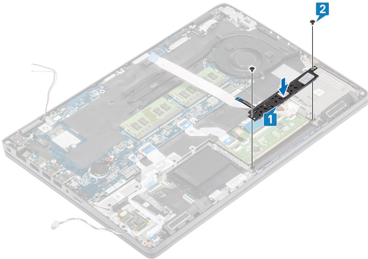
3. Verbinden Sie das flexible Flachkabel (FFC) des Smart Card-Lesegeräts mit der USH-Platine [1].
