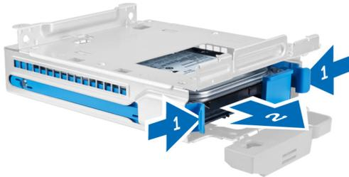
4. Biegen Sie die Festplattenhalterung und entfernen Sie die Festplatte aus der Halterung.
