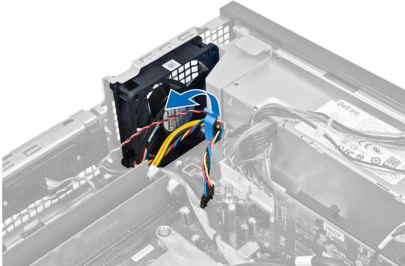
5. Heben Sie den Systemlüfter aus den Gummiösen, mit denen der Lüfter am Computer befestigt ist. Drücken Sie dann die Gummiösen entlang der Schlitze nach innen und schieben Sie sie durch das Gehäuse.
