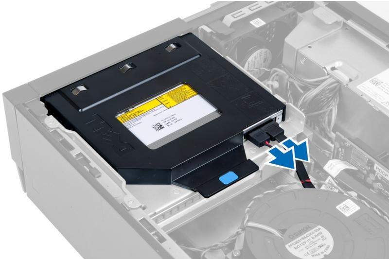
4. Heben Sie die blaue Lasche an und schieben Sie das optische Laufwerk nach innen, um es vom Computer zu entfernen.
