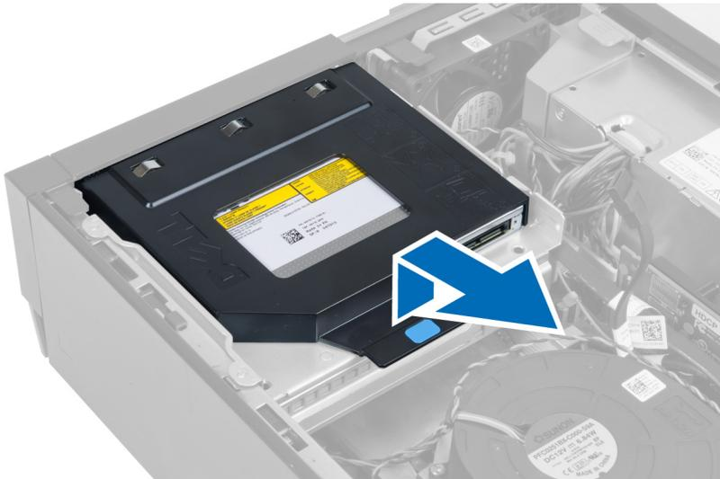
5. Drücken Sie auf die Seiten der Halterung, um das optische Laufwerk zu entfernen.
