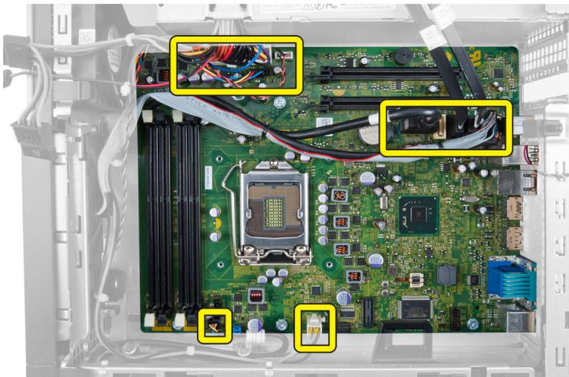
4. Entfernen Sie die Schrauben, mit denen die Systemplatine am Gehäuse befestigt ist.
