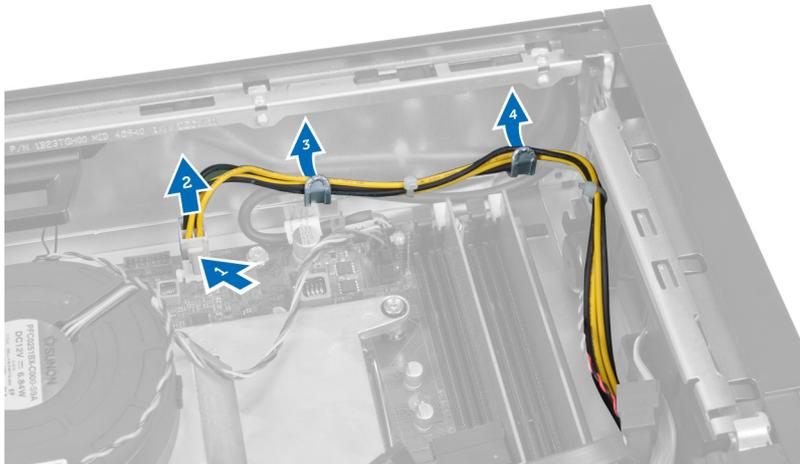
4. Lösen Sie das Stromversorgungskabel aus der Fixierung.
