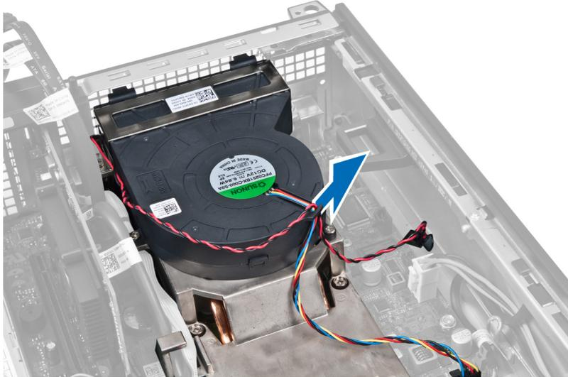
5. Drücken Sie auf die Klammer, um das Lüfterkabel von der Systemplatine zu lösen und zu trennen.
