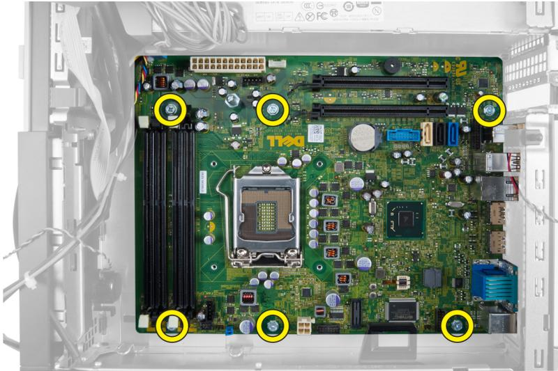
5. Drehen Sie die Sechskantschraube entgegen dem Uhrzeigersinn und entfernen Sie sie von der Systemplatine.
