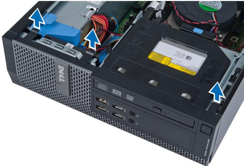
4. Drehen Sie die Blende seitlich vom Computer weg, um die Haken auf der gegenüberliegenden Seite der Blende vom Gehäuse zu entfernen. Heben Sie dann das Gehäuse an und entfernen Sie die Frontblende vom Computer.
