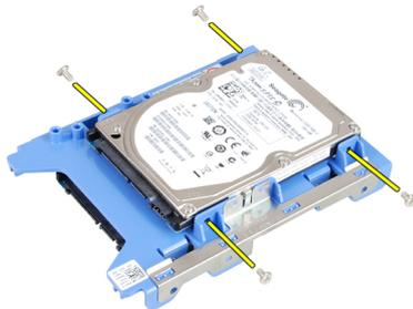
6. Lösen Sie die Schrauben, mit denen die Festplatte an der Unterseite der Festplattenhalterung befestigt ist.
