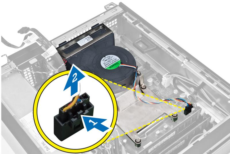
6. Lösen Sie die unverlierbaren Schrauben, heben Sie die Kühlkörperbaugruppe an und entfernen Sie sie dann vom Computer. Legen Sie die Baugruppe mit nach unten gerichtetem Lüfter und nach oben weisender Wärmeleitpaste ab.
