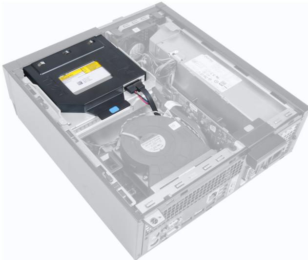
3. Trennen Sie das Datenkabel und das Stromversorgungskabel von der Rückseite des optischen Laufwerks.
