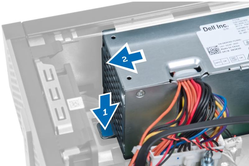
9. Heben Sie das Netzteil aus dem Computer heraus.
