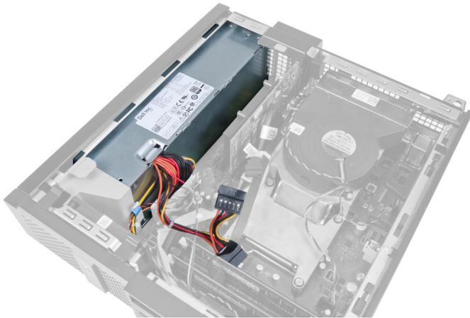
3. Trennen Sie das 4-polige Stromversorgungskabel von der Systemplatine und fädeln Sie es aus den Gehäuseklammern.
