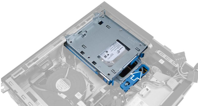
5. Drehen Sie den Laufwerkträger am Griff nach oben und heben Sie den Laufwerkträger vom Gehäuse weg.
