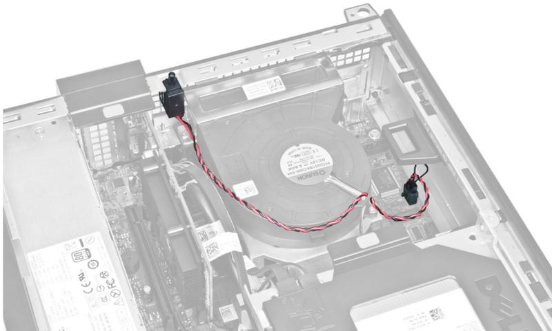
3. Trennen Sie das Kabel des Eingriffschalters von der Systemplatine.
