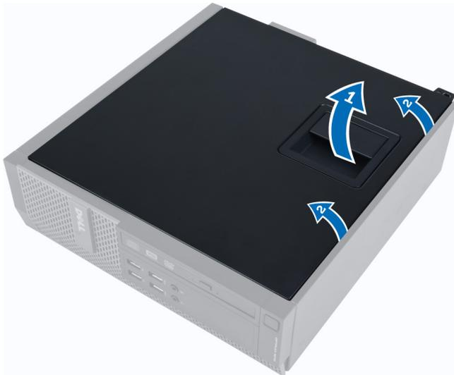
3. Heben Sie die Abdeckung in einem Winkel von 45 Grad an und entfernen Sie sie vom Computer.
