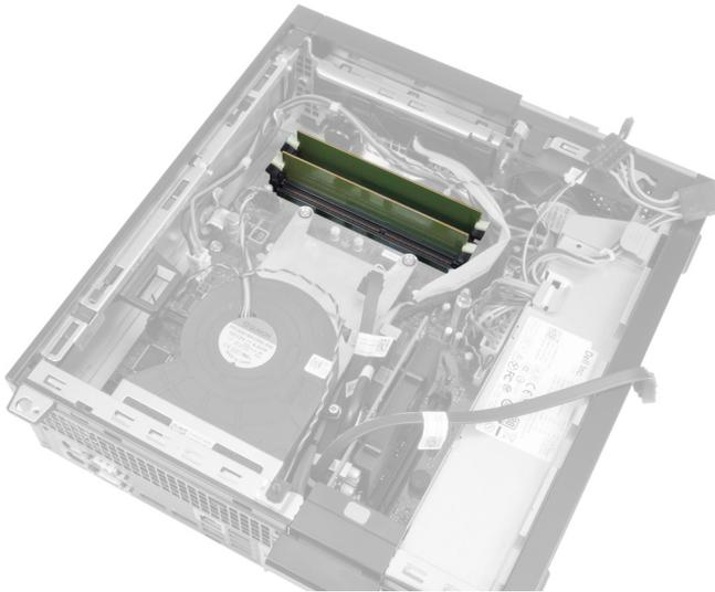
4. Heben Sie die Speichermodule aus den Anschlüssen auf der Systemplatine.
