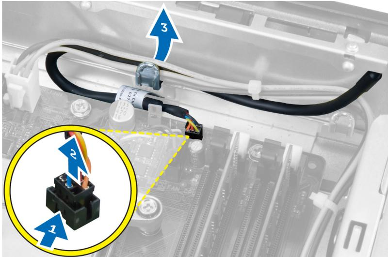
4. Drücken Sie die Halteklammern nach innen und schieben Sie das Netzschalterkabel durch die Computervorderseite nach außen.
