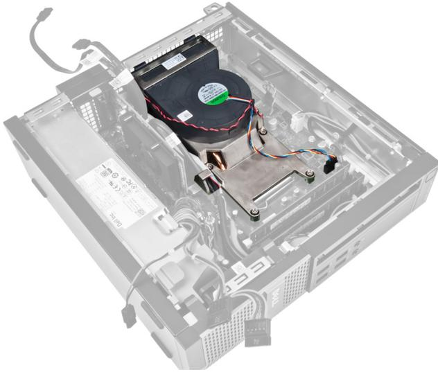
3. Drücken Sie auf die Klammer, um das Kabel der Kühlerbaugruppe von der Systemplatine zu lösen und zu trennen.
