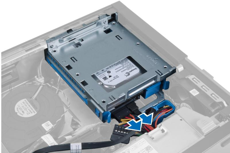
4. Schieben Sie den Laufwerkträgergriff in Richtung Computerrückseite in entriegelte Position.
