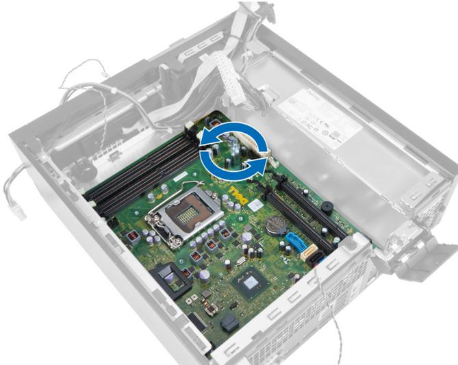
6. Entfernen Sie die Systemplatine aus dem Gehäuse.
