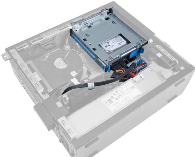
3. Trennen Sie das Datenkabel und das Stromversorgungskabel von der Rückseite des Laufwerks.
