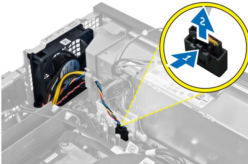
4. Lösen Sie das Kabel aus der Fixierung.
