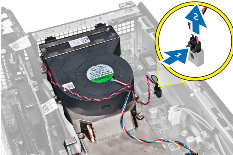
4. Lösen Sie das Kabel der Eingabe/Ausgabe-Platine bzw. das FlyWire-Kabel aus der Kabelführung am Kühlkörper.
