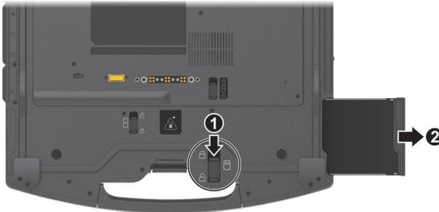
4. Stecken Sie die neue Festplatte bis zum Anschlag in den Einschub und achten Sie dabei auf seine Ausrichtung. Der Verriegelung sollte in der verriegelten Position einrasten (🔒).
