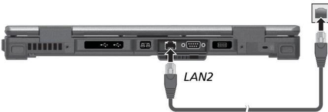
**HINWEIS:** Das LAN2-Modul implementiert DSM (Deep Slumber Mode bzw. Tiefschlafmodus), um Batteriestrom zu sparen. Nur bei angeschlossenem LAN-Kabel wird das LAN-Modul mit Strom beliefert. Dies bedeutet, dass das LAN-Modul nicht im „Gerätemanager“ (**Device Manager**) von Windows erscheint, wenn das LAN-Kabel nicht angeschlossen ist, und erscheint, wenn das Kabel angeschlossen ist.
