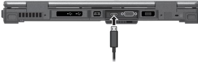
**ACHTUNG:** Dieser Anschluss unterstützt nicht die „USB Power Delivery“-Spezifikationen. Verbinden Sie diesen Anschluss niemals mit einer Stromquelle.
