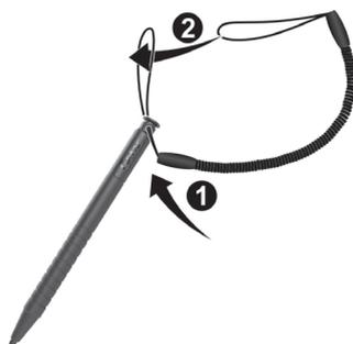
2. Stecken Sie das andere Schlaufenende durch das Loch am Computer (wie nachstehend mit **1** gekennzeichnet). Stecken Sie dann das Stylusende durch die Schlaufe (wie nachstehend mit **2** gekennzeichnet); ziehen Sie das Band fest.
