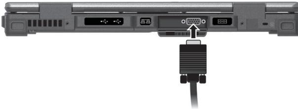
Der Monitor sollte per Standard ansprechen. Falls nicht, können Sie den Bildschirm durch Drücken von **Fn+F5** zum Monitor, zu beiden Anzeigen (Simultananzeige) oder zu mehreren Anzeigeräten schalten. In Windows Vista können Sie die Einstellungen der Anzeige in den Eigenschaften von **Anzeigeeinstellungen** ändern.
