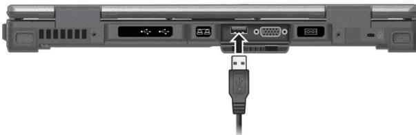
Ein angeschlossenes Gerät wird entweder über den externen Netzstrom (bei angeschlossenem Netzteil) oder über den Akku des Computers (falls das Netzteil nicht angeschlossen ist) aufgeladen. In letzterem Fall stoppt der
