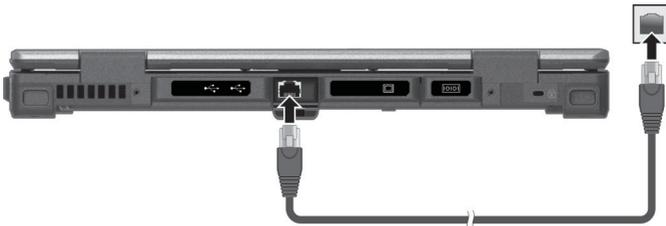
Ausgewählte Modelle verfügen über ein zweites LAN-Modul, sodass Sie sich mit zwei Netzwerken gleichzeitig verbinden können.
