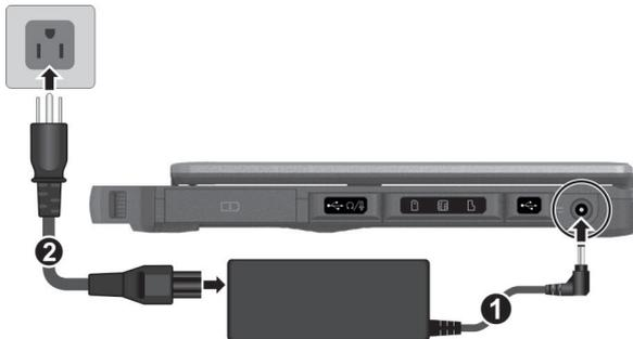
3. Wenn das Netzteil angeschlossen ist, leuchtet die Betriebsanzeige, was bedeutet, dass Strom von der Steckdose zum Netzteil und in Ihren Computer fließt. Sie können den Computer jetzt einschalten.
