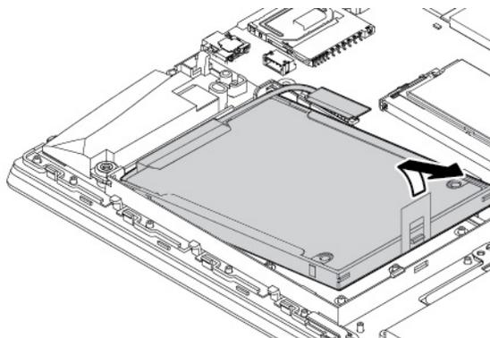
8. Ziehen Sie das Kabel vom Speicherlaufwerk ab.
