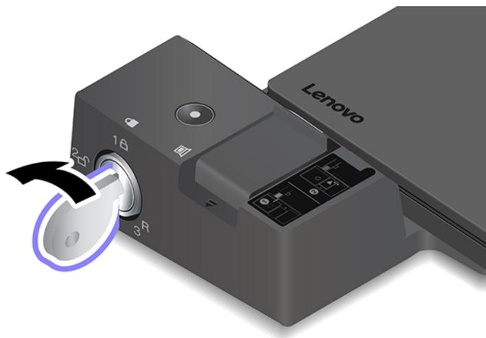
2. Schieben Sie die Verriegelung in die angezeigte Richtung **1**, um den Computer freizugeben. Fassen Sie dann an beide Seiten des Computers, um ihn zu entfernen **2**.
