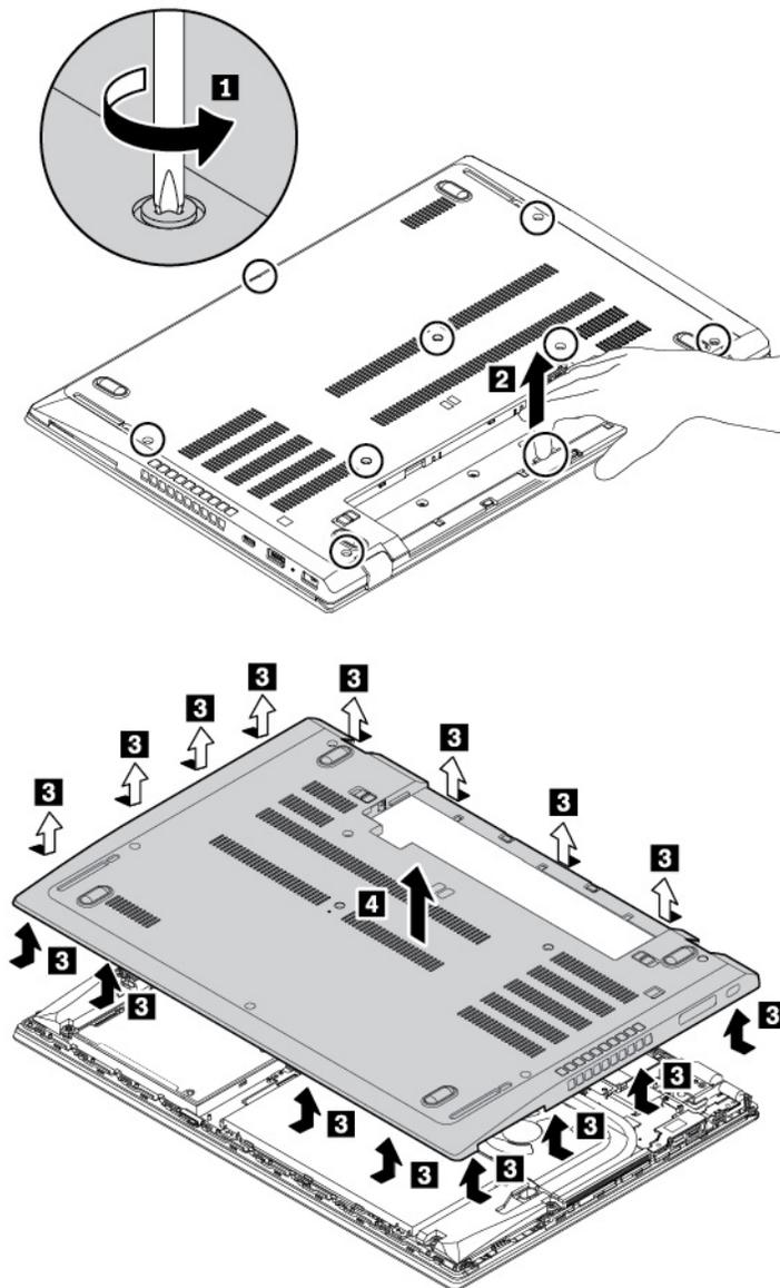
7. Befestigen Sie die Grundplattenabdeckung **1**. Vergewissern Sie sich, dass die Verriegelungen unter der Grundplattenabdeckung sicher sitzen. Ziehen Sie dann die Schrauben fest, um die Baugruppe für die untere Abdeckung zu fixieren **2**.
