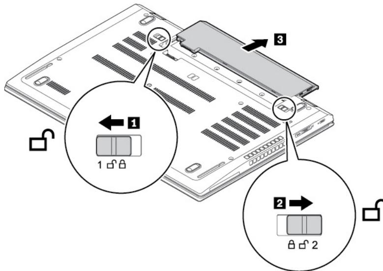
5. Setzen Sie einen neuen Akku so ein, dass er hörbar einrastet. Stellen Sie sicher, dass sich beide Akku-Verriegelungen in der gesperrten Position befinden.
