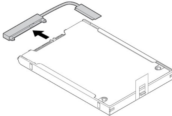
9. Entfernen Sie die Halterung des Speicherlaufwerks.
