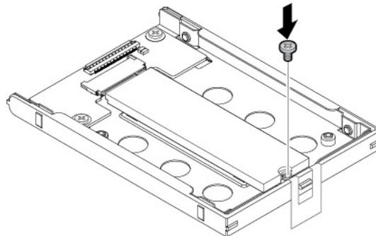
3. Bringen Sie die Schutzabdeckung an **1** und befestigen Sie sie mit den Schrauben **2**.
