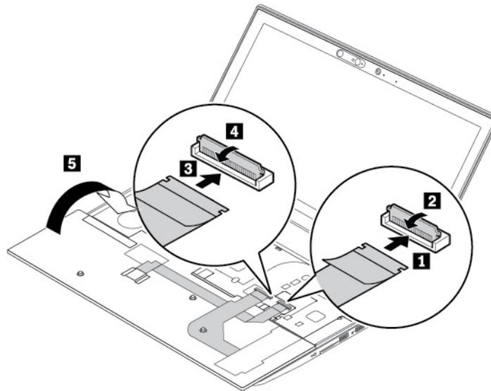
2. Setzen Sie die Tastatur in die Tastaturblende ein. Stellen Sie sicher, dass sich die vordere Kante der Tastatur (die zum Bildschirm weisende Kante) unter dem Rahmen der Tastaturblende befindet.
