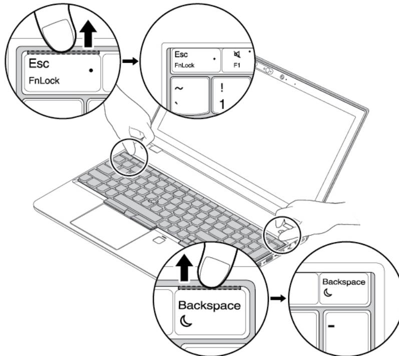
7. Schwenken Sie die Tastatur leicht nach oben, wie mit dem Pfeil **1** angezeigt. Wenden Sie die Tastatur dann in die von Pfeil **2** angegebene Richtung.
