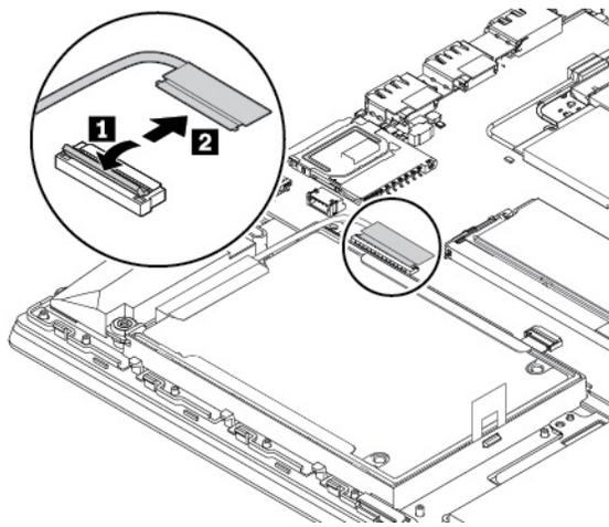
7. Ziehen Sie an der Lasche, um den Adapter zu entfernen, an dem das M.2 Solid-State-Laufwerk installiert ist.
