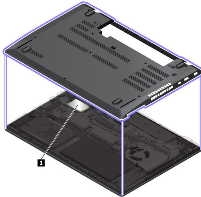
**Anmerkung:** Stellen Sie für das durch den Benutzer installierbare Modul sicher, dass Sie nur ein von Lenovo autorisiertes drahtloses Modul verwenden, das speziell für dieses Computermodell getestet wurde. Andernfalls wird der Computer beim Einschalten eine Sequenz von Fehlercode-Signaltönen ausgegeben.
