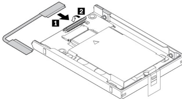
5. Setzen Sie den Adapter ein **1** und drehen Sie ihn dann nach unten **2**. Vergewissern Sie sich, dass der Adapter fest im Steckplatz sitzt.
