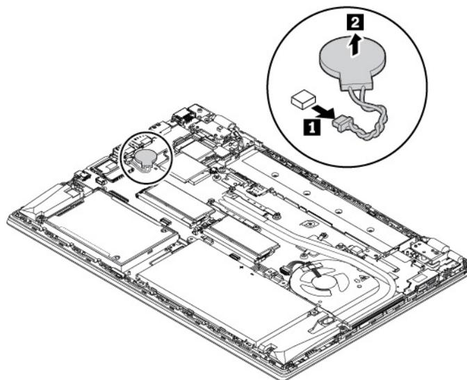
7. Setzen Sie die neue Knopfzellenbatterie **1** ein und schließen Sie dann den Stecker **2** an.
