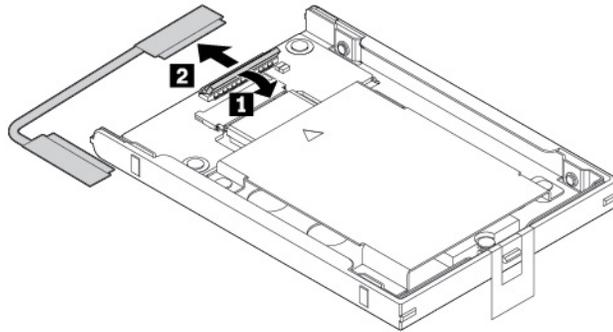
9. Entfernen Sie die Schrauben, die die Schutzabdeckung sichern **1** und entfernen Sie dann die Abdeckung **2**.
