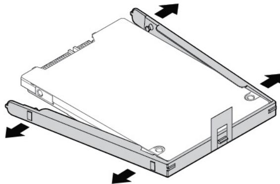
Gehen Sie wie folgt vor, um das Speicherlaufwerk zu installieren:
